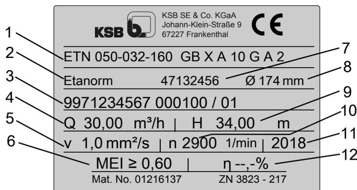
**Fig. 5: Targhetta costruttiva (esempio) Etanorm**
