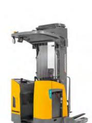
Carrello elevatore a montante retrattile con sistema a pantografo
