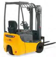
Carrello elevatore elettrico a tre ruote con trazione posteriore
