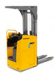
Elevatore elettrico con sedile laterale
