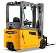
Carrello elevatore elettrico a tre ruote con trazione anteriore
