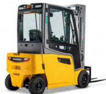
Carrello elevatore elettrico a quattro ruote
