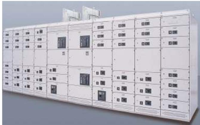
La struttura dei quadri Modul 700 IMEB è costituita da elementi componibili in lamiera zincata, “sendzimir” pressopiegata, di spessore 25/10 mm, e da pannellature esterne in lamiera pressopiegata a singola piega, sufficiente, grazie allo spessore di 20/10 mm, a rendere robuste e prive di spigoli taglienti le portelle ed i pannelli di chiusura del quadro.
