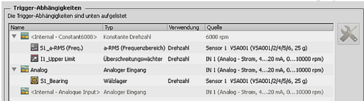
Zeigt die Abhängigkeiten der vorhandenen Trigger und deren Abhängigkeit zu den konfigurierten Objekten.
