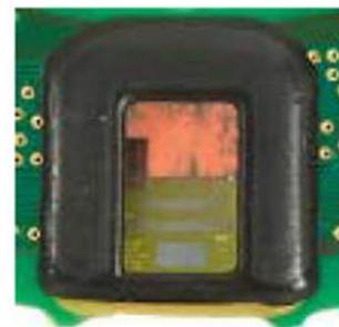
**Nuovo:** PCB con scansione e di interfaccia ASIC
