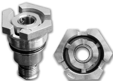
La tenuta meccanica a cartuccia, completamente sostituibile, permette una riduzione dei tempi di manutenzione programmata dell'impianto. A partire dai modelli da 5,5 kW non è necessario smontare il motore per sostituire la tenuta.
