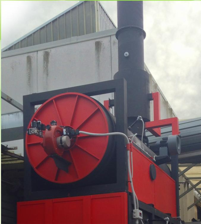
Forno per la post-combustione dei fumi a funzionamento **pirolitico con combustione controllata**, costruito con lamieroni di acciaio al carbonio elettrosaldati e rinforzati con trafilati e profilati anch'essi in acciaio al carbonio elettrosaldati.
