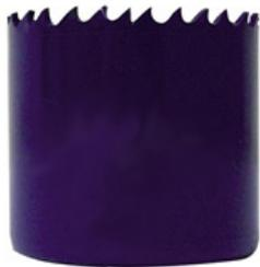
Dentatura in HSS M3 e corpo in acciaio legato. Max profondità di foratura = 10 MM - Profondità utile di taglio = 30 MM. Massima resistenza ad urti e strappi grazie alla saldatura laser tra denti e corpo. Consigliata per tagli rapidi e perfetti su: acciai inossidabili e comuni, ghisa, metalli ferrosi e non ferrosi, legno compatto anche con presenza di chiodi, compensati e materie plastiche. Si suggerisce di seguire scrupolosamente le velocità di taglio consigliate. Confezionate singolarmente
