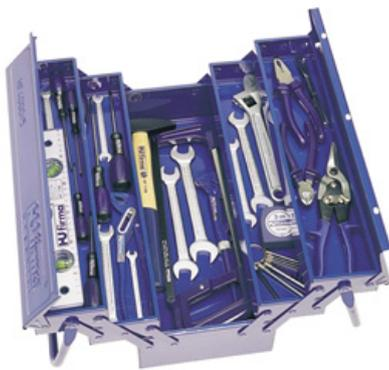
Modello professionale a 5 cassette con apertura a pantografo. Completa di 38 pezzi per meccanici (HF 4005/1) e 35 pezzi per elettricisti (HF 4005/2). Rivetti maggiorati ad alta resistenza. Manici reclinabili lateralmente, in tubo Ø 12 mm, spessore 2 mm. Coperchi con chiusura di sicurezza lucchettabile. Saldature ad alta resistenza realizzate in ambiente ad atmosfera controllata. Verniciatura elettrostatica.
