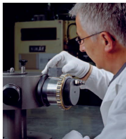
12: Determinazione della distanza dallo spallamento dell'albero
