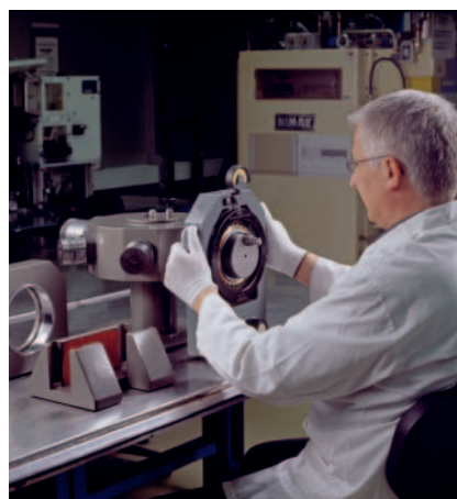
11: Applicazione dello strumento di misura del cerchio d'involuppo rulli
