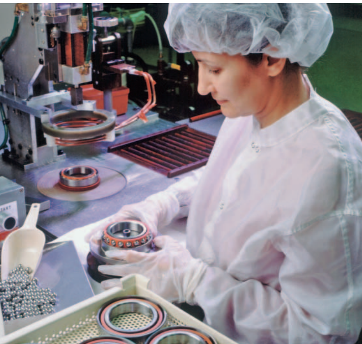
... durante il montaggio dei cuscinetti
