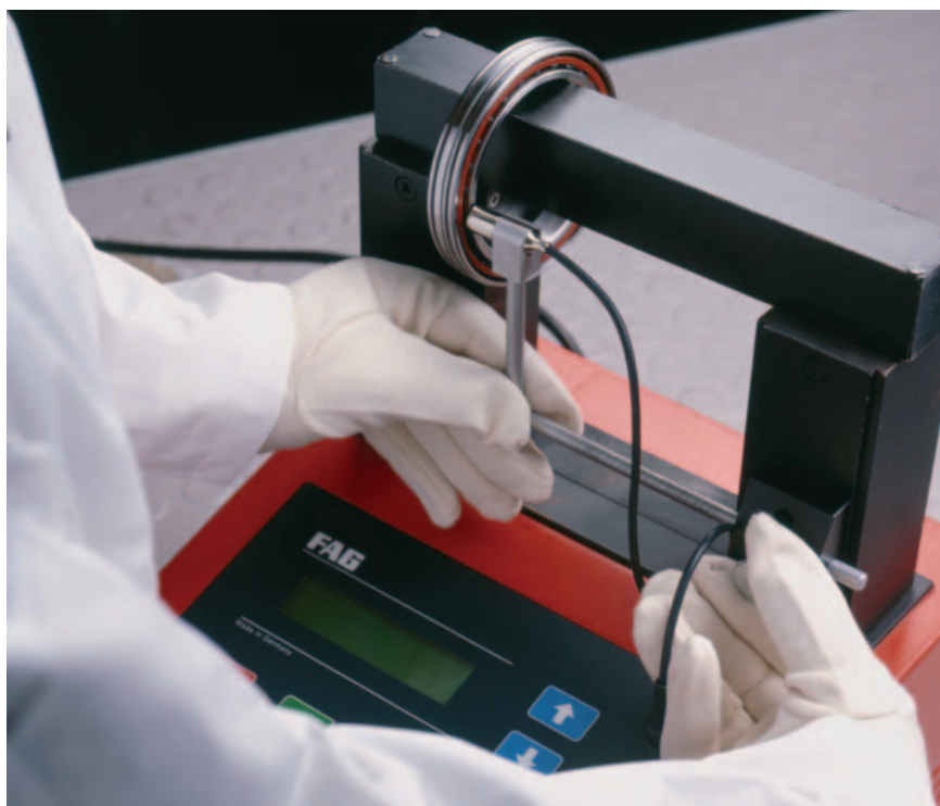
3: Riscaldamento di un cuscinetto per mandrini mediante un riscaldatore ad induzione
