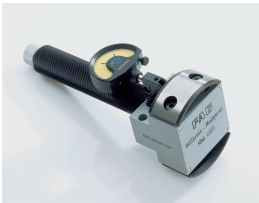
14: Strumento di misura del cerchio d'involuppo rulli FAG MGI 21 per l'impostazione del gioco radiale o del precarico di cuscinetti a rulli cilindrici con anello interno estraibile
