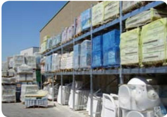
Anche per i pallets di ceramiche e sanitari realizziamo impianti particolarmente resistenti ai carichi gravosi degli articoli, la sicurezza, è inoltre garantita, grazie agli accessori standard di due tipi: kit trave centrale o pianetti di grande portata a chiusura completa del piano di carico.
