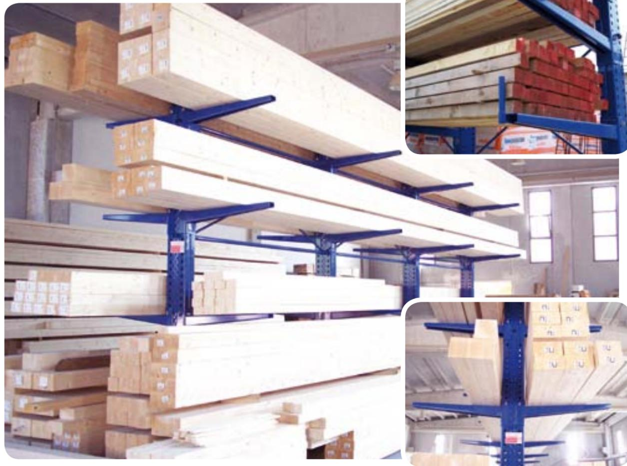
Le travi lamellari e tavole hanno come caratteristica principale la lunghezza, per questo il ns ufficio tecnico ha progettato delle strutture standard che garantiscono, una volta sistemate sull'impianto, la perfetta planarità dei profili al fine di evitare il danneggiamento degli stessi. Le versioni con tetto e chiusura laterale, assicurano la protezione dei materiali dagli agenti atmosferici.
