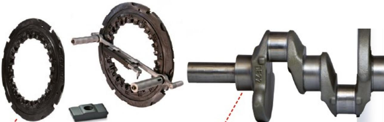
Dalle foto si evince che la lavorazione avviene con utensili posti all'interno della fresa, i quali consentono di ottenere un'elevata velocità di taglio accoppiata ad un'elevata stabilità e rigidità dell'insieme.
