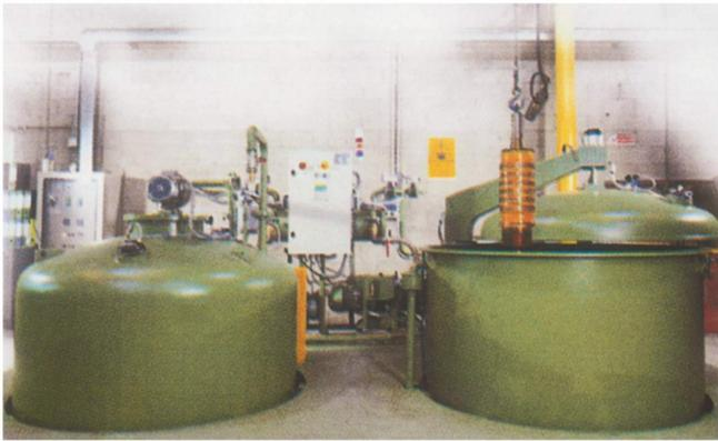
Impianto di impregnazione con resina sotto vuoto, capacità 9 metri cubi
