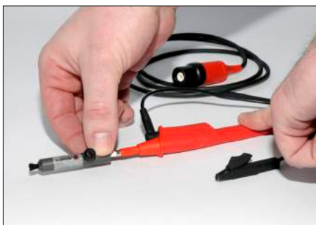
5. Installare la punta AEGIS® SVP sulla punta della sonda
