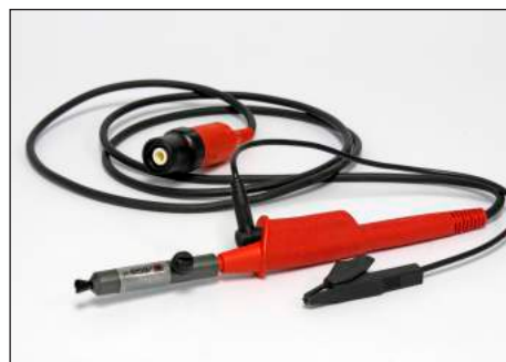
6. Fissare la punta alla sonda con la vite. Fare attenzione a non stringere troppo.
