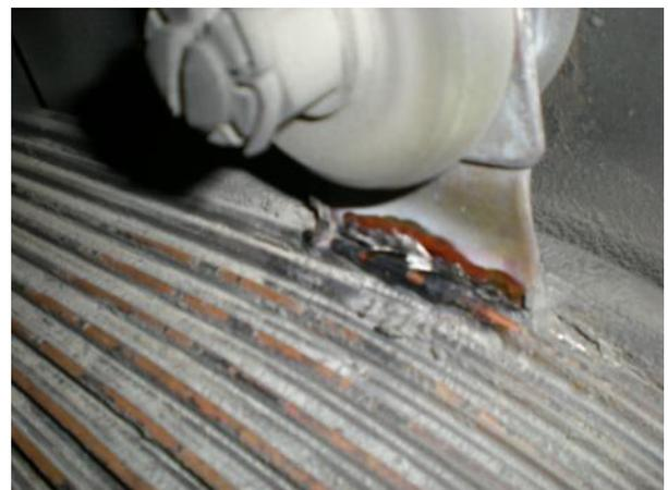
Figura 33: connessione interpolare
