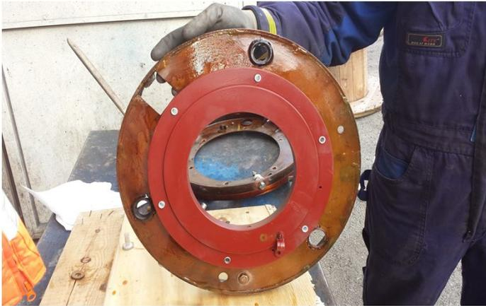
La piastra portadiodi è stata completamente riparata, ricostruito interamente l'isolamento con la sostituzione di tutti i 6 diodi.
