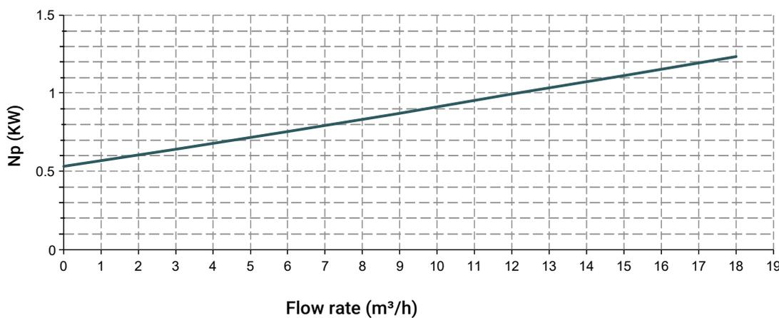
Le curve e le prestazioni sono riferite a pompe testate con acqua a 20°C motore a due poli 50 Hz (2900rpm).
