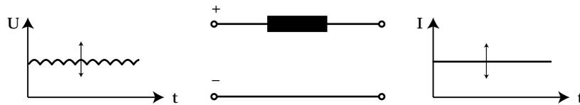
Fig. 2.10 Circuito intermedio a CC variabile
