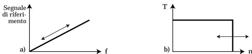
Fig. 3.16 Collegamento fra il segnale di riferimento e le caratteristiche di coppia del motore
