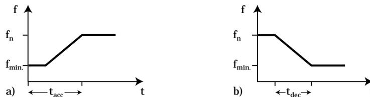
Fig. 3.18 Tempi di accelerazione e decelerazione
