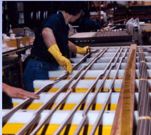
Preparazione dei conduttori elementari
