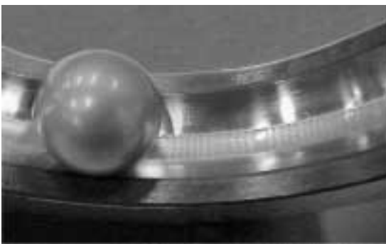
Figura 1: Le correnti d'albero possono provocare nei cuscinetti la formazione di scanalature in sequenza regolare sulle piste dei cuscinetti.
