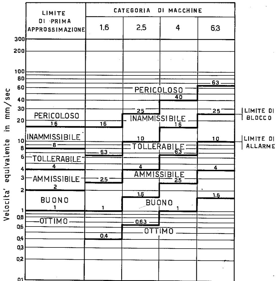
Fig. 16 - Livelli di velocità equivalente di vibrazione per la valutazione dell'intensità di vibrazione.
