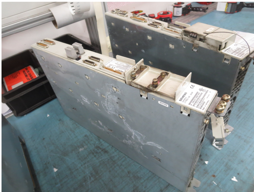
SEGNI ACQUA ZONA LATERALE APPARECCHIATURE
