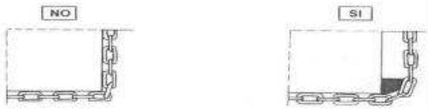
Figura 4 – Spessori per evitare danneggiamenti della fune o della catena
