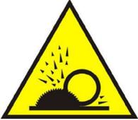
**Situazioni di pericolo:** Ogni volta che si transita o si lavora nelle vicinanze di macchine o attrezzature con organi meccanici in movimento, per la sagomatura di materiali (flessibile, sega circolare, scalpelli, martelli demolitori, ecc.) o durante le fasi di demolizione (ristrutturazioni, esecuzione di tracce nei muri, ecc.).
