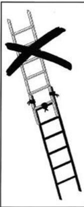
In una scala doppia, con gradini solo sulla parte anteriore, non si può salire sulle traverse presenti nell'elemento posteriore.
