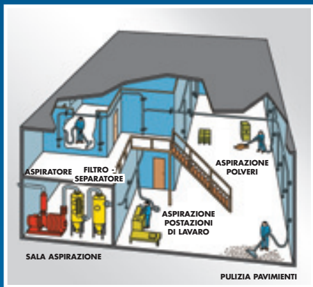
Pulizia pneumatica centralizzata
