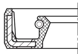
Gli anelli di tenuta vengono generalmente forniti con superficie esterna in elastomero e superficie esterna metallica. Combinazioni di entrambe le versioni o di versioni speciali sono fornibili su richiesta.
