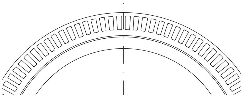
Esempio di anello di tenuta con corona forata con funzione di sensore.
