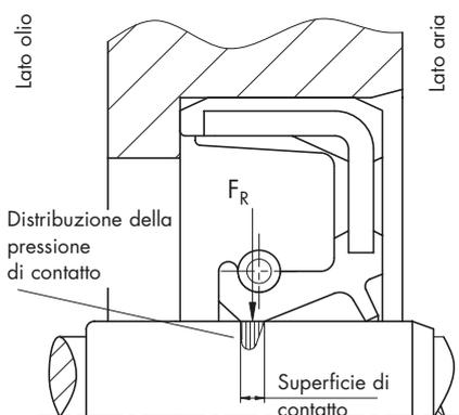
Poco dopo la messa in funzione di un anello di tenuta nuovo, il labbro di tenuta, nella zona di contatto, subisce un fenomeno di assestamento, causato dal movimento relativo fra il labbro di tenuta e l'albero, che genera sul labbro di tenuta delle microscopiche sporgenze in direzione assiale. L'orientamento di queste sporgenze dipende dalla distribuzione della pressione nella zona di contatto e
