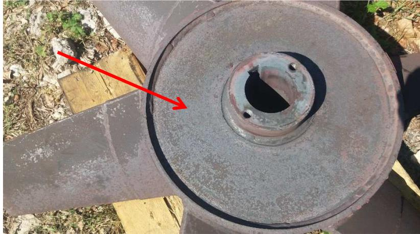
4. RIPARAZIONE STRUTTURA ESTERNA CON: DISTACCO LAMIERA IN INCONEL SUL DIAMETRO 480mm, DISTACCO VECCHIA BOCCOLA, RICOSTRUZIONE SEDE BOCCOLA E RIPARAZIONE CON SALDATURA LAMIERA D480mm, COSTRUZIONE NUOVA BOCCOLA
