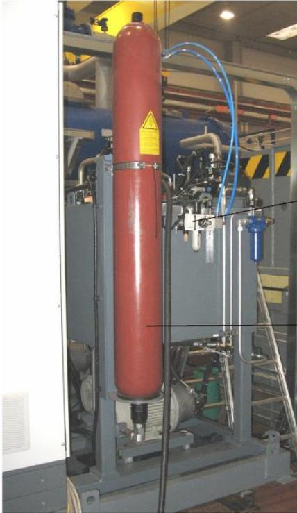
P1= Attacco generale aria compressa macchina con elettrovalvola di intercettazione e scarico impianto, filtro riduttore con manometro e pressostato di segnalazione presenza aria. Pos. da 1 a 4 S.P. [74YV10-153SP1]
