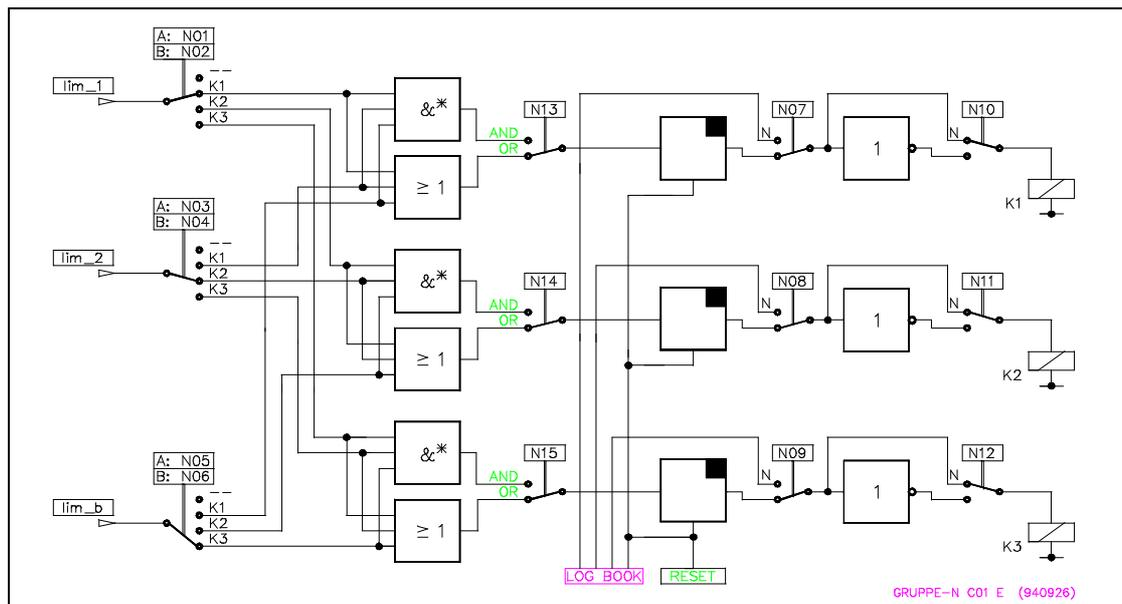
Fig. 5 - 7 : Parameter Group N, Relais Configuration
