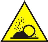
**Situazioni di pericolo:** Ogni volta che si transita o si lavora nelle vicinanze di macchine o attrezzature con organi meccanici in movimento, per la sagomatura di materiali (flessibile, sega circolare, scalpelli, martelli demolitori, ecc.) o durante le fasi di demolizione (ristrutturazioni, esecuzione di tracce nei muri, ecc.).
