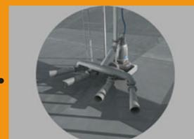
Sistemi di aerazione per impianti di trattamento acque reflue.
