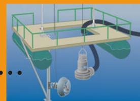
Risospensione di solidi sedimentati e pompaggio su zattera
