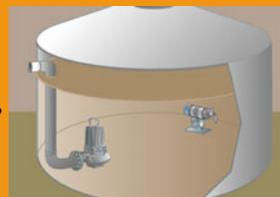
Miscelazione e pompaggio con macchine antideflagranti nella produzione biogas
