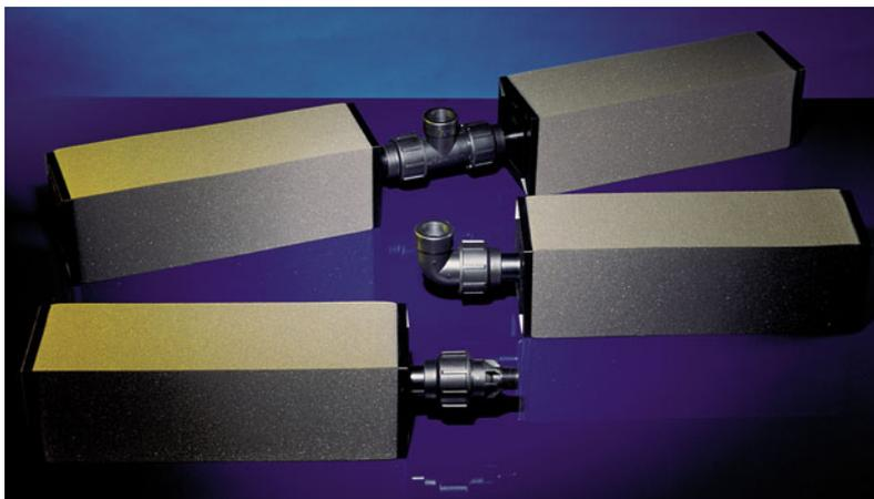
essere montato a 8-10 cm dal fondo vasca per evitare ristagno di fanghi nella zona sottostante. Montare il diffusore orizzontalmente con tolleranza di 5 mm fra le estremità, per portata pari o superiore a quella nominale. Per portata inferiore a quella nominale ridurre la tolleranza a 2,5 mm. Per diffusori montati in batteria sul medesimo tubo, il dislivello, rispetto al piano orizzontale, tollerato fra il primo e l'ultimo diffusore, è il seguente:
