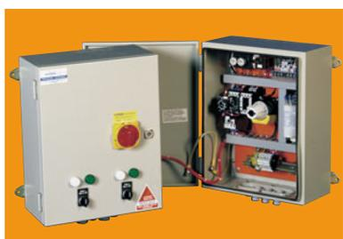
Le configurazioni prevedono versioni per interno IP54, per esterno IP55, opzioni quali la strumentazione, l'unità di allarme in batteria tampone, ecc. Gli avviatori possono essere diretti fino a 11 kW e stella-triangolo per potenze maggiori. Questa gamma di quadri elettrici offre un ottimo rapporto prezzo-prestazioni.
