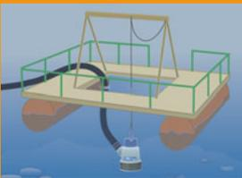
Drenaggio con pompa sospesa a zattera o con pompa con galleggiante
