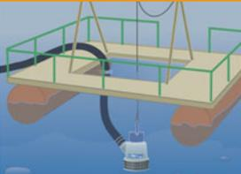
Drenaggio con pompa sommersibile montata su zattera
