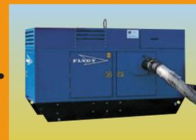
By-pass fognari e pompaggi di emergenza con pompe autoadescanti diesel o elettriche
