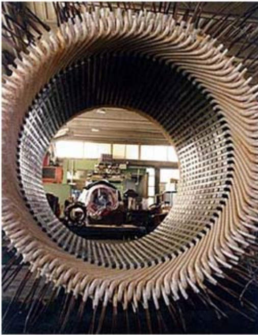
Statore di motore da 6 MW, 6 kV con avvolgimento embricato 4 poli.
