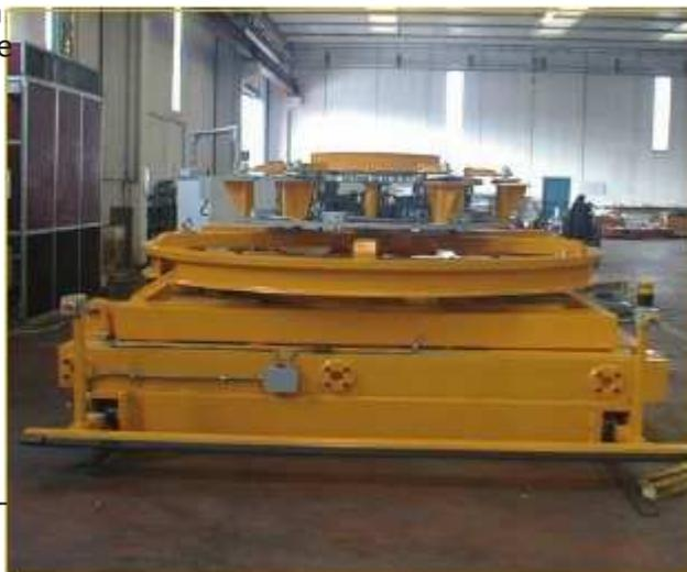
Macchina ribaltatore parte posteriore Booster Missile Ariane
