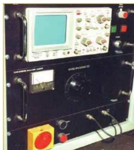
Surge-test per il Collaudo delle Macchine Elettriche
