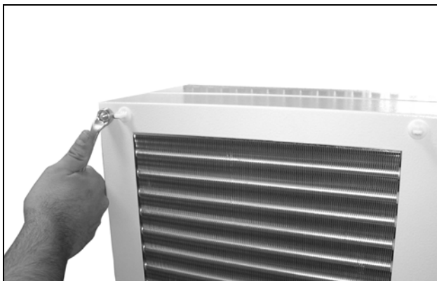
Fig. 44: Smontare la cuffia (allentare quattro dadi)
