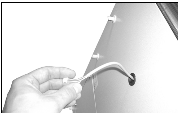
Fig. 45: Far arretrare il cavo del display
