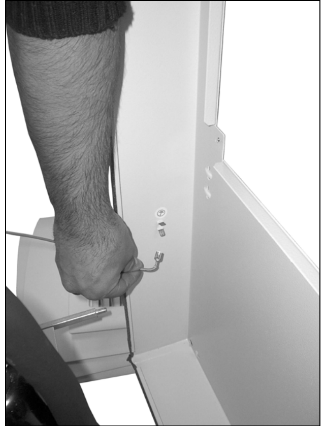
Fig. 73: Staccare il cavo di massa (2)
