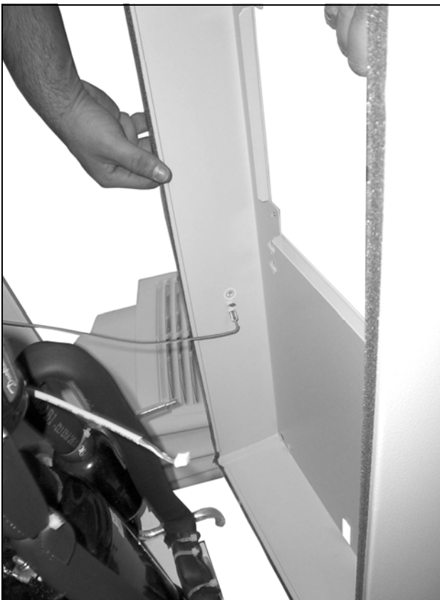
Fig. 72: Staccare il cavo di massa (1)
