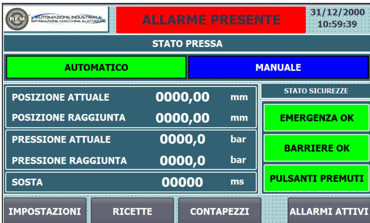
Nella sezione dello *stato sicurezze*, è visualizzato lo stato di emergenza (“Emergenza OK”) e della barriera ottica (“Barriere OK”). In particolare la segnalazione sarà:
