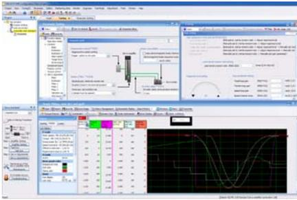
Il comodo software di configurazione per personal computer basati su Windows consente una perfetta messa a punto dei servoamplificatori e dei servomotori collegati.
