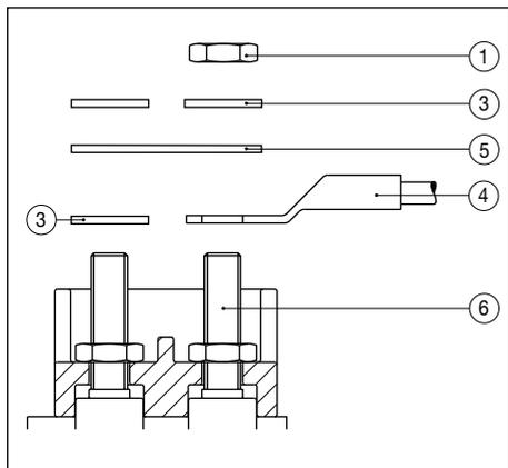
Fig. 1 - Sequenza di collegamento 56÷80 (carcassa alluminio)
