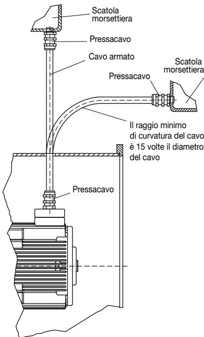
Fig. 4 - Uscita cavi versione con pressacavo
