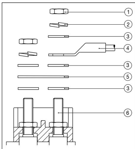
Fig. 2 - Sequenza di collegamento 63÷250 (carcassa ghisa)
