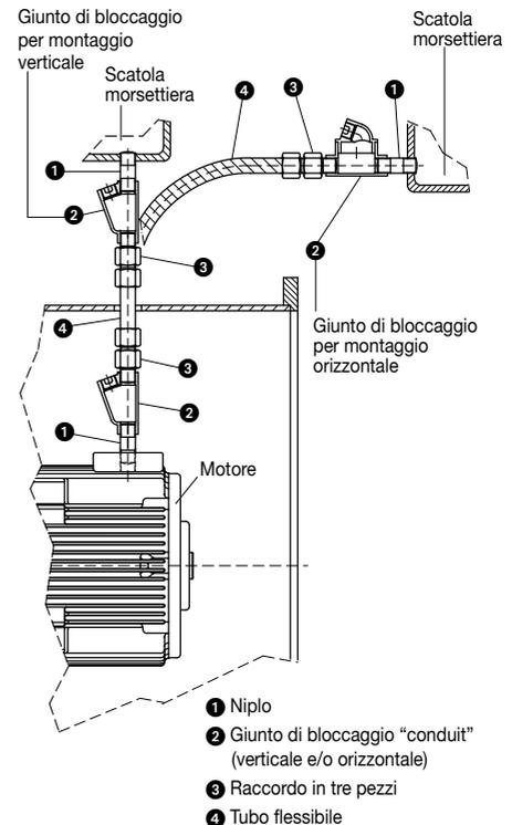
Fig. 5 - Uscita cavi versione con "conduit"
