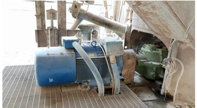
Questa relazione mette in evidenza delle anomalie sul cuscinetto lato accoppiamento del motore mulino carbone dal primo giorno di servizio dell'ultima revisione.
