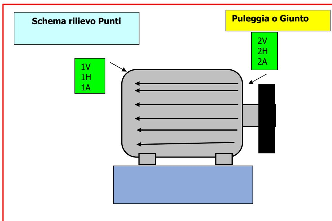
In figura è rappresentato lo schema dei punti di misura sul motore.
