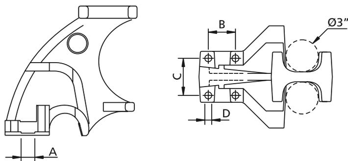
Questo accessorio può essere abbinato ad ogni elettropompa Zenit (verificare la presenza della predisposizione sul disegno delle dimensioni di ingombro delle singole pompe) rendendola accoppiabile ai DAC con tubi guida da 3" ed ai DAC Flygt con medesimo diametro di tubi guida.
