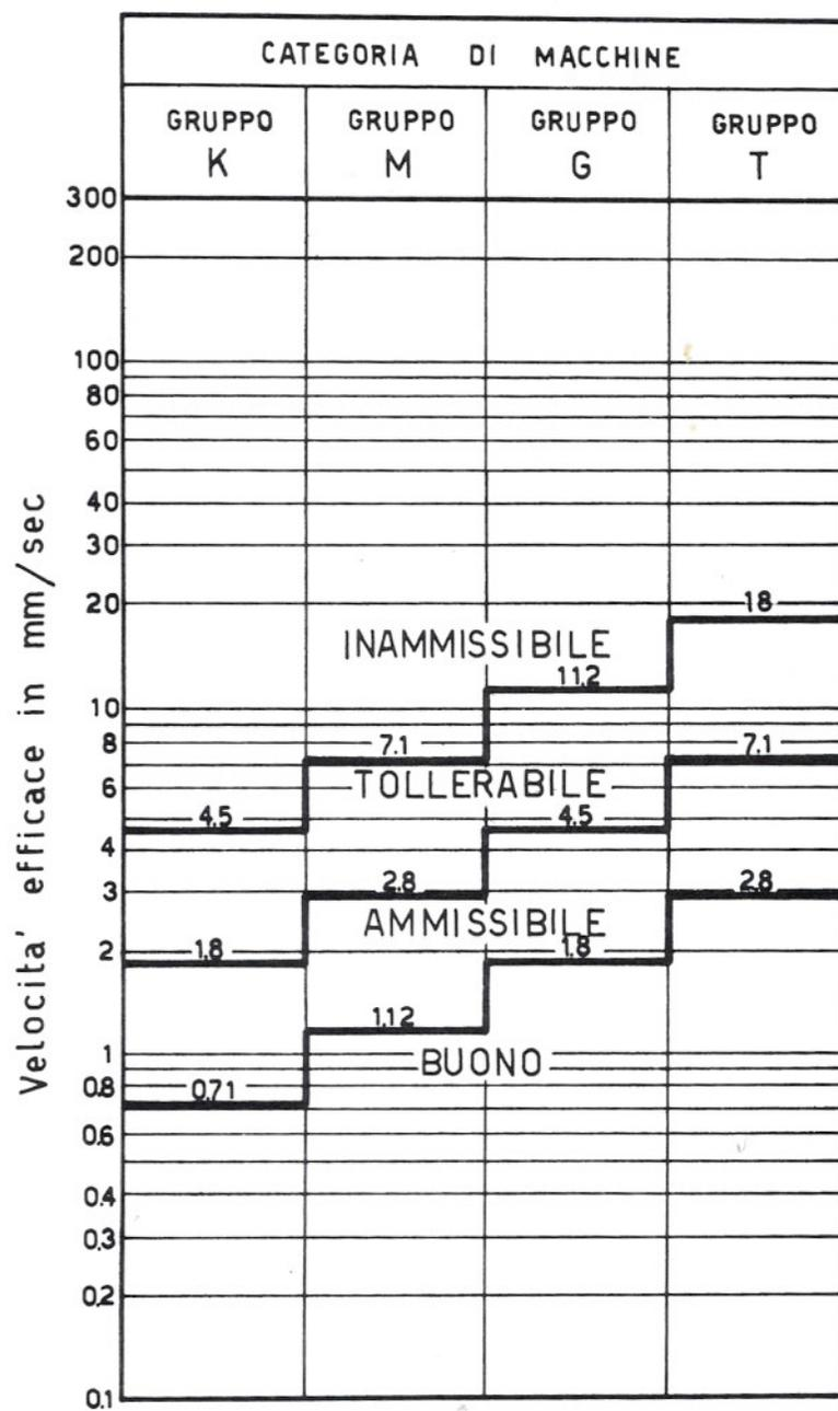
Fig. 17 - Valutazione in base alla velocità efficace di vibrazione sec. Norma VDI - 2056.
