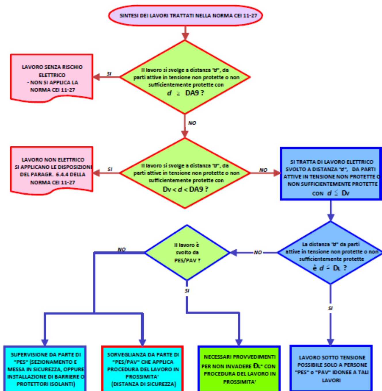
Fig.5 diagramma di flusso per lavori elettrici in BT (rif. Allegato B norma CEI 11/27, ed. IV)
