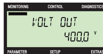
La schermata Tensione del circuito intermedio visualizza la tensione del circuito intermedio DC attuale.
