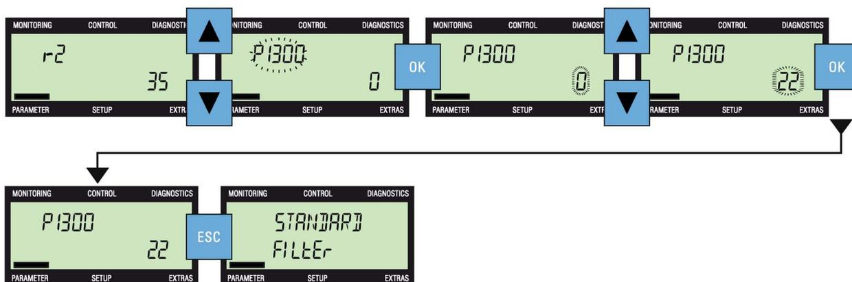
Figura 9-3 Modifica di parametri (metodo per scorrimento)
