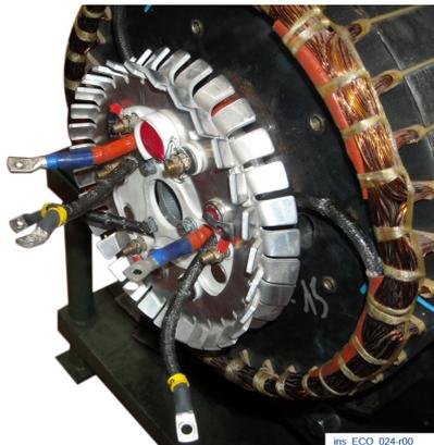
Inserire il ponte diodi rotante e avvitare le 3 viti M5 a 3.3 Nm.
