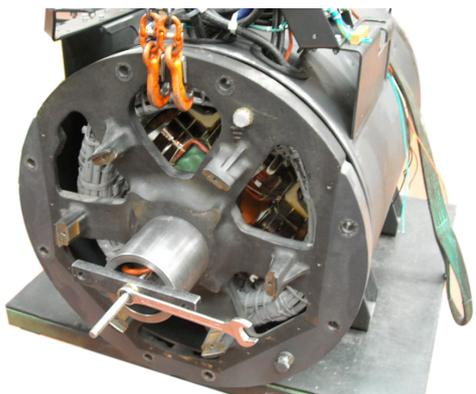
Con l'ausilio di un adeguato sistema di sollevamento sollevare il coperchio posteriore e metterlo in posizione.
