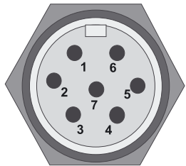
Fig. 7.4-2: Interfaccia del ricevitore/Transceiver verso la macchina, connettore MIN-Series (vista sui pin)
