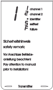
Fig. 5.1-1: Visualizzazioni di stato dell'emettitore
