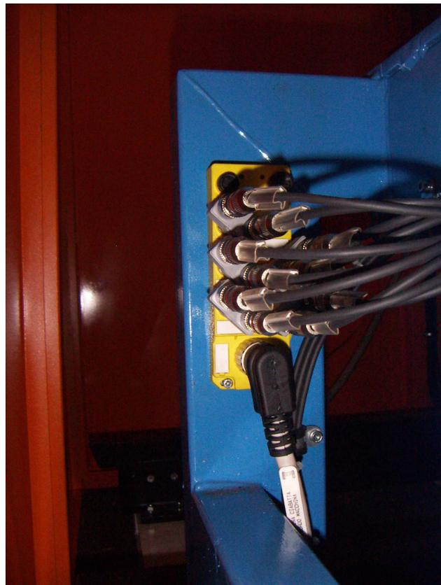
Figura 6.2-8 – Esempio I/O remoti
