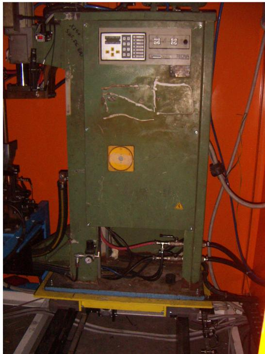
Figura 2.2-18 – Esempio Saldatrice Dadi
