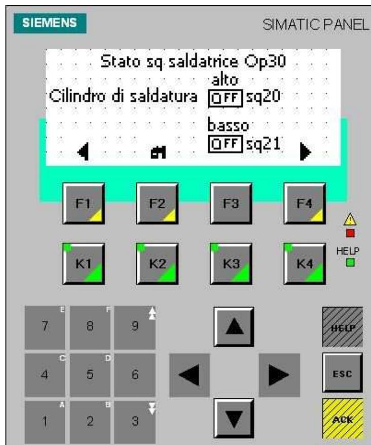
**Figura 6.6-14 – Pagina Stato SQ cilindro saldatrice OP.30.**
