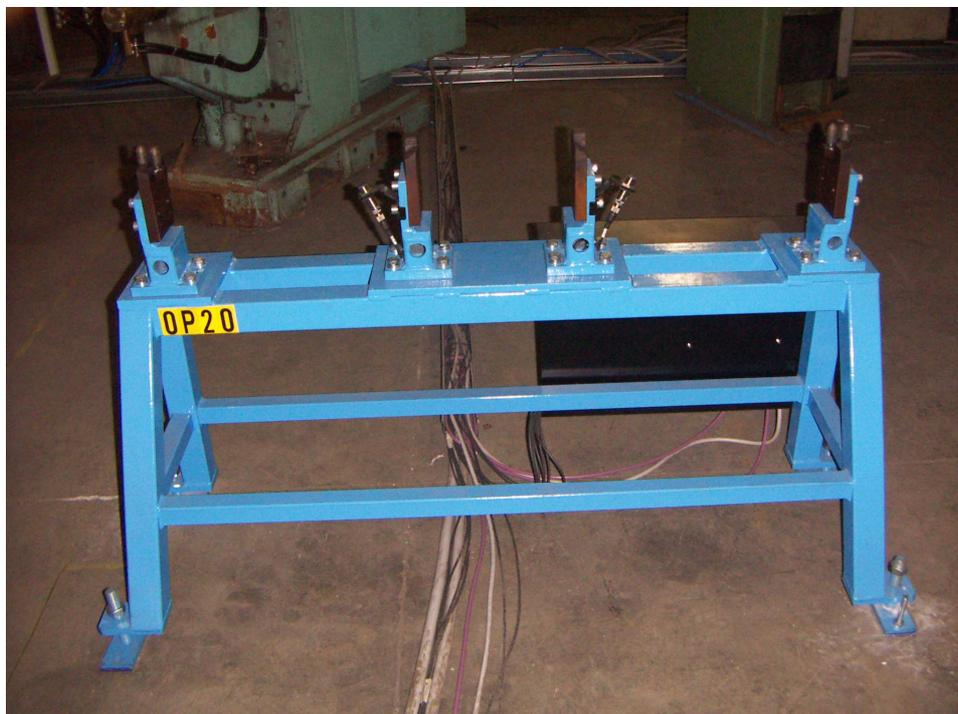
**Figura 2.2-2 – Attrezzatura di geometria OP.20**
