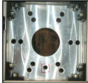
**Figura 2.2-8 - Flangia di giunzione telaio-robot**
