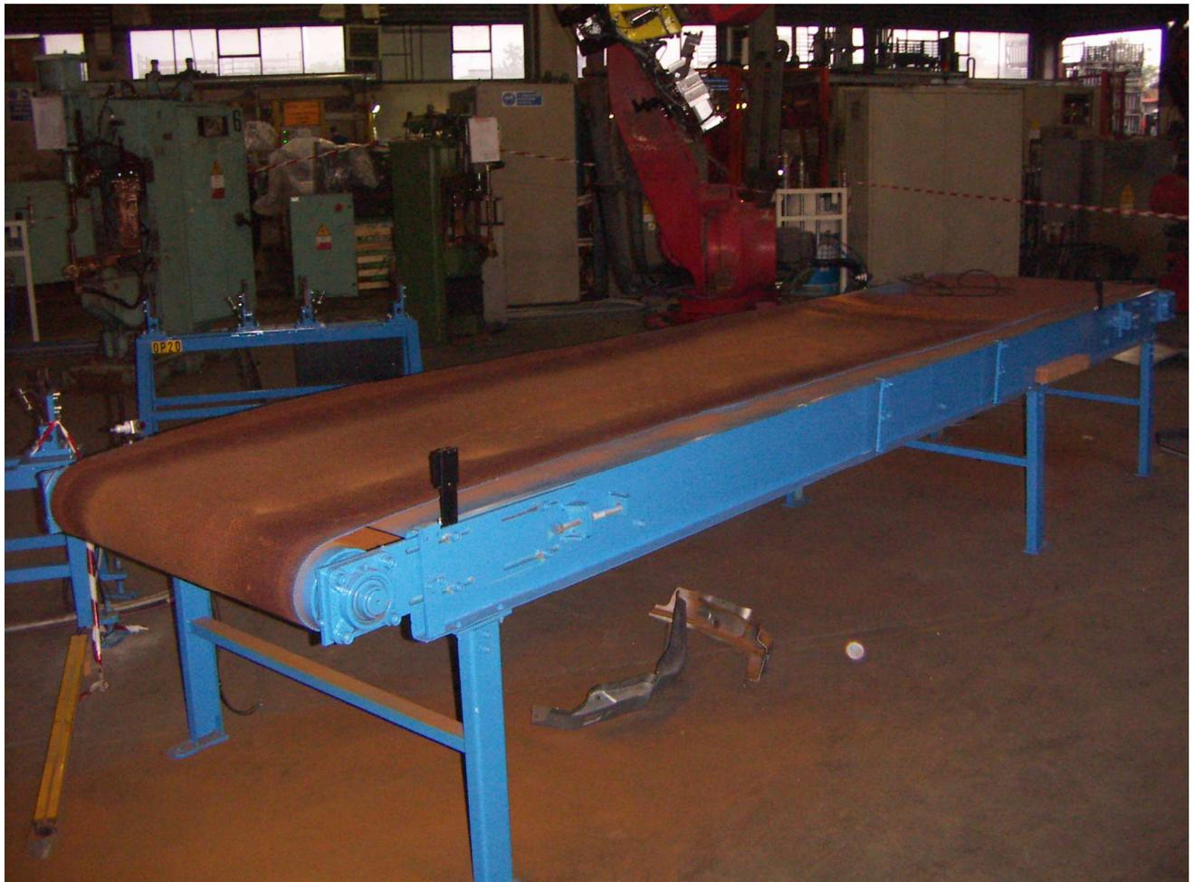
Figura 2.2-21 – Trasportatore a nastro
