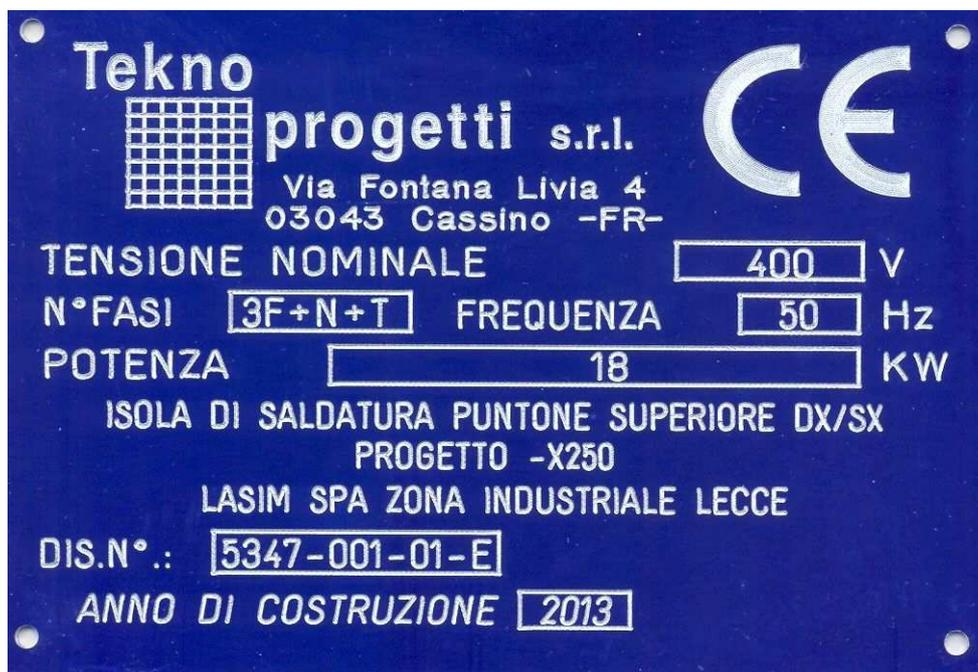
Figura 3 – Targa identificazione macchina.
